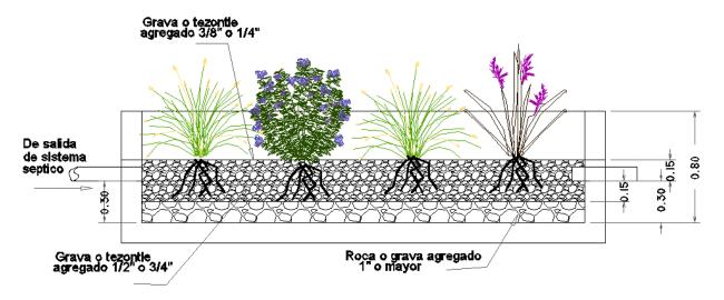
Se deberá de colocar plantas con raíces largas colocándolas de 10 a 15 cm por debajo de la superficie de grava, cuidando que las raíces queden lo mas profundas posibles, las plantas no se necesita la colocación de tierra, el humedal se deberá de llenar con agua cuidando que todas las raíces queden húmedas o mojadas, si se cuenta con la descarga de la fosa séptica en el momento de realizar el trasplante es mejor. Nunca se deberá de dejar sin agua, ya que las plantas se secarían.
