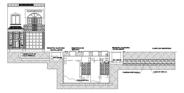
Un factor importante para el buen funcionamiento del sistema de tratamiento es: EL TERRENO DE INFILTRACIÓN
