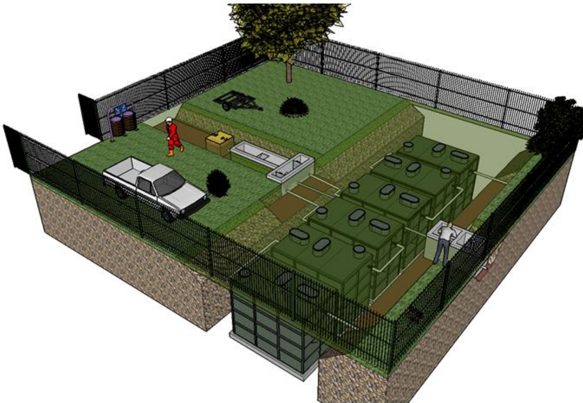
Arreglo con 6 equipos
